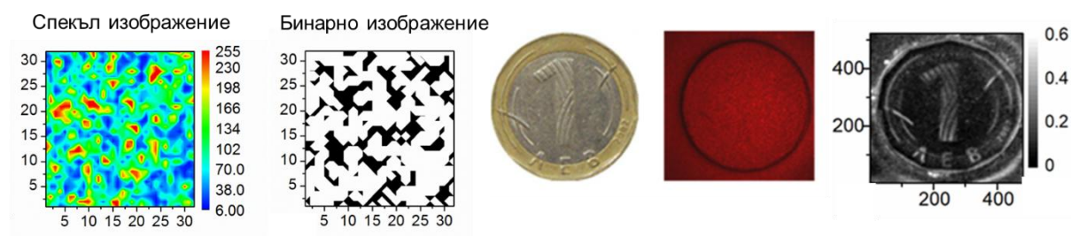
Фиг.5. Отляво надясно: 8-битово спекъл изображение, трансформацията му в бинарно изображение, монета от 1 лев като тестов обект, спекъл изображение на монетата, покрита с непрозрачна боя, карта на активността, показваща различната скорост на изпарение на боята върху монетата след бинаризация на записаните изображения.
